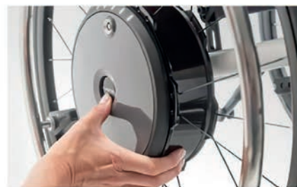
Zur Abnahme des Rades Steck- achsen-Knopf drücken.
